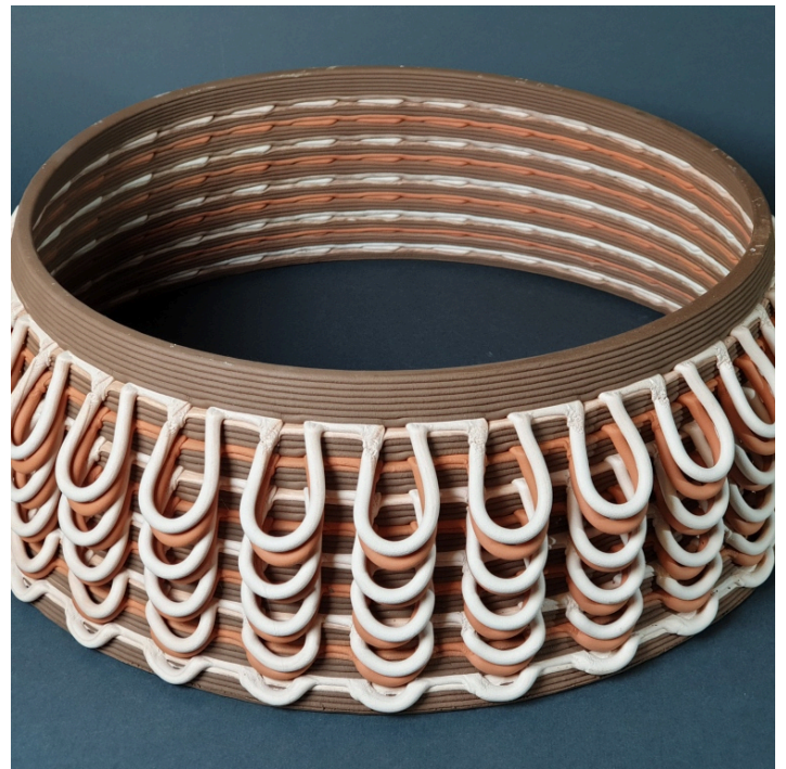
Il. 8. Wydruk 3D z zastosowaniem trzech rodzajów mas, proj. Piotr Waśniowski, 2021; fot. Piotr Waśniowski ( instagram.com/p/CuB1KziMT-R/ ?utm_source=ig_web_copy_link&igsh=MzRI0DBiNWFIZA== [data dostępu: 11.3.2026])
